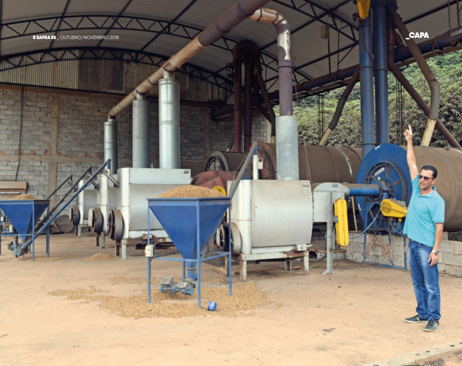
_Cleiton mostra o galpão com o secador que vai funcionar com fumaça canalizada.
